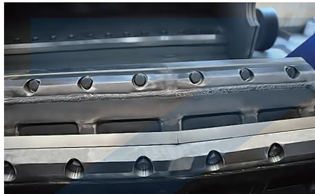
Je nach Aufgabenstellung stehen für die GSH-Baureihe verschiedene Rotoren zur Verfügung. Alle Rotoren arbeiten nach V-Schnittgeometrie, die stets ein qualitativ hochwertiges Mahlgut liefert.
